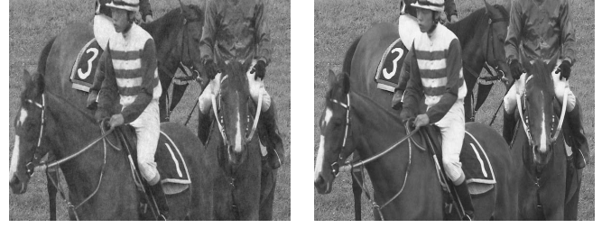
(a) LVC-NIC: PSNR=30.83dB (b) LVC-OSP-IC: PSNR=38, 64dB.
